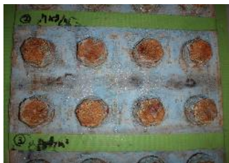
バイオハクリX-WB 塗付量: 0.7kg/m 2 塗付後 24時間経過状態 (1回目)
