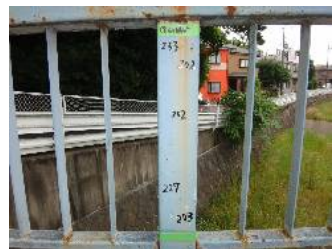
③ 高欄部 既存塗膜厚: 229 μm 試験区画面積: 0.10m(W) × 0.50m(W) = 0.050m 2
