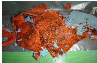
はく離除去塗膜の回収状態 ≒ 「湿潤シート状態」
