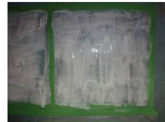
バイオハクリX-WB 塗付完了状態(1回目) 塗付量: 0.5kg/m 2 (≒ 45g/0.090m 2 )
