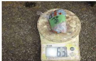
はく離回収した塗膜重量測定状態 63g/0.090m 2 ≒ 700g/m 2
