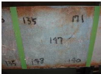
バイオハクリX-WB 塗付量: 0.5kg/m 2 塗付後 24時間経過状態 (1回目)
