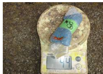
はく離回収した塗膜重量測定状態 44g/0.050m 2 ≒ 880g/m 2
