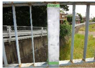
バイオハクリX-WB 塗付完了状態(1回目) 塗付量: 0.5kg/m 2 (≒ 25g/0.050m 2 )
