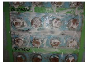
バイオハクリX-WB 塗付完了状態(1回目) 塗付量: 0.7kg/m 2 (≒ 34g/0.048m 2 )
