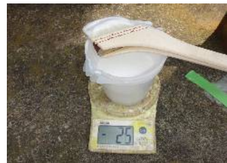
試験区画への塗付量確認(1回目) 塗付量: 0.5kg/m 2 (≒ 25g/0.050m 2 )
