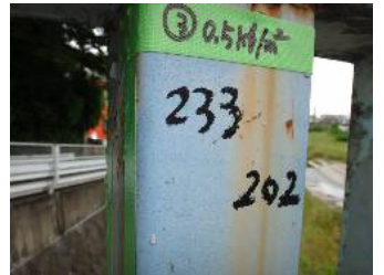
③ 高欄部 既存塗膜厚: 229 μm 試験区画面積: 0.10m(W) × 0.50m(W) = 0.050m 2
