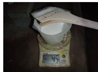
試験区画への塗付量確認(1回目) 塗付量: 0.5kg/m 2 (≒ 45g/0.090m 2 )
